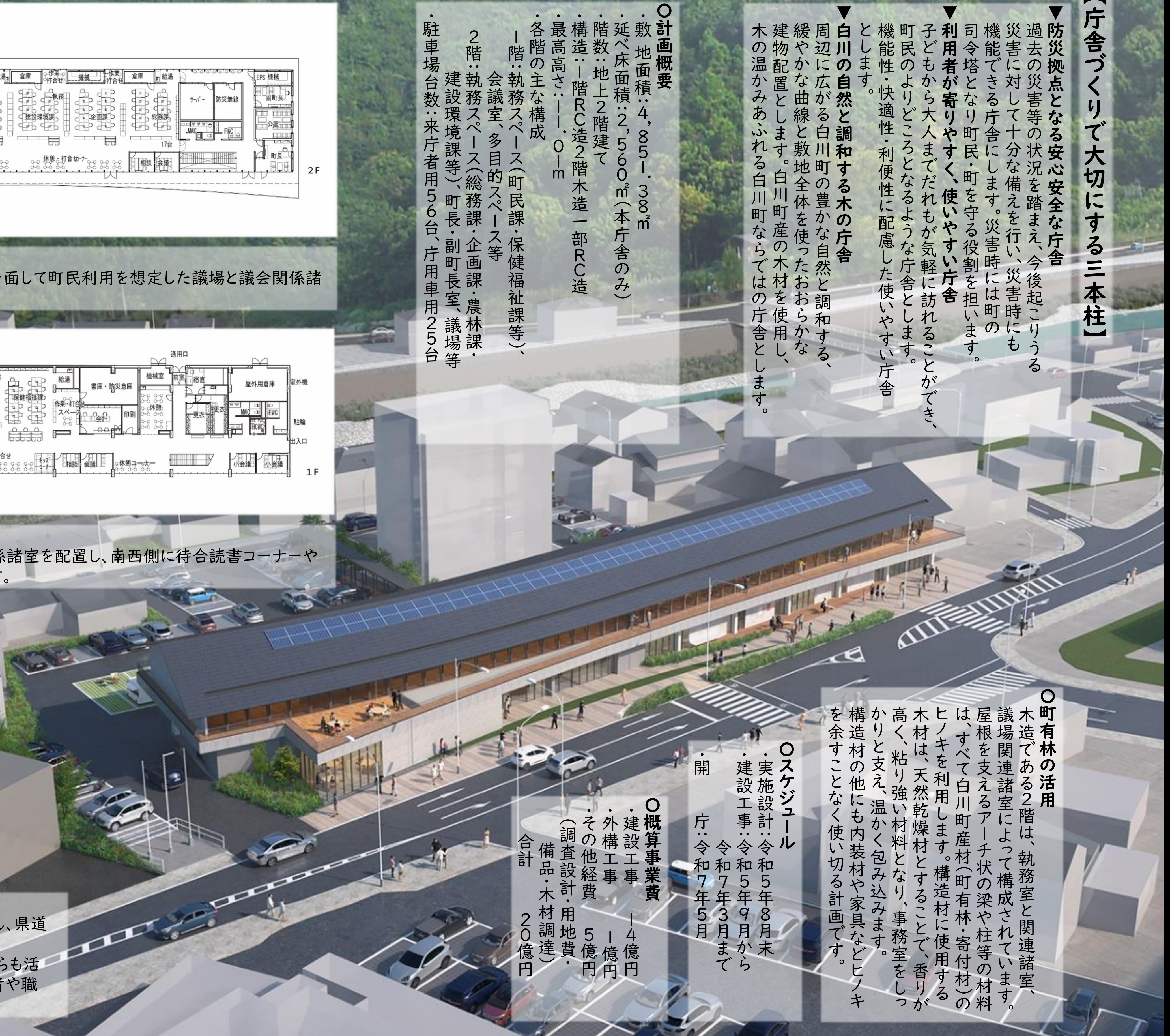
▲配置計画図 ・不整形で間口が長く、住宅地と隣接する敷地に対し、県道側に寄せて配置し、両側が表となる配置とします。 ・県道側の歩道には「白川テラス」を配置し、県道からも活動の雰囲気が感じることができるとともに、来庁者や職員が使いやすい大きな平面形状を確保します。
